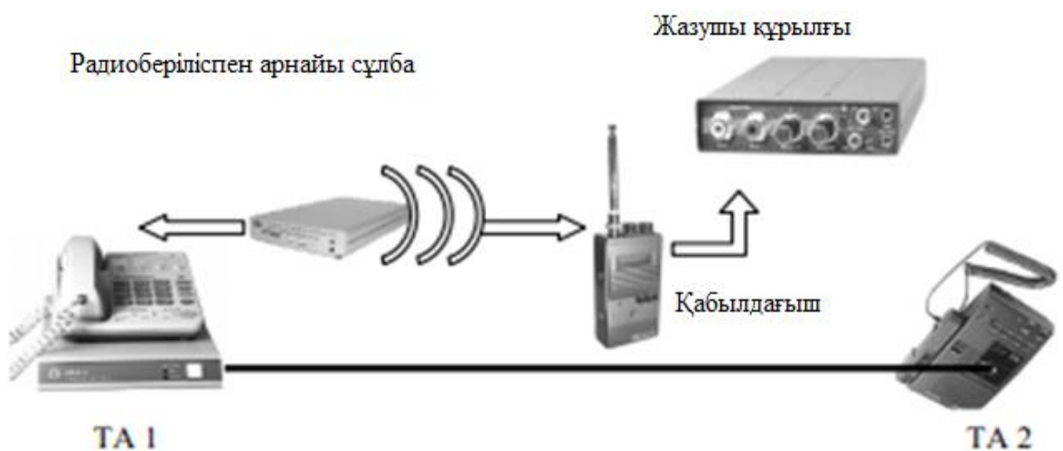
Сурет 1.5 –Радио арналарды қолдану арқылы ақпаратты алу сұлбасы
